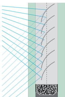
Im geschlossenen Zustand der Lamellen wird eine hohe Reflexion der Sonneneinstrahlung erreicht. Dadurch kommt nur ein geringer Prozentsatz der Wärmeenergie ins Rauminnere, beste g-Werte werden erzielt.
