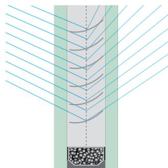
Die nach Sonnenstand ausgerichtete geneigte Position der Lamellen leitet viel einfallendes Tageslicht in den Innenraum. Optimale Lichtverhältnisse für Bildschirmarbeitsplätze entsprechend der vorgeschriebenen Norm entstehen.
